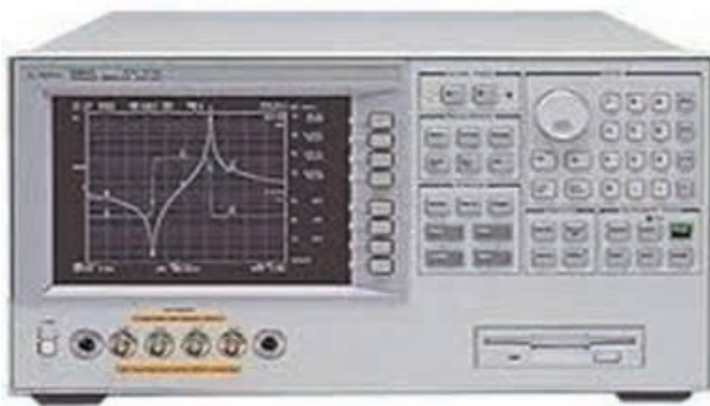
그림 9. 임피던스 측정 장비: (a) LCR 측정장치 (b) 본 연구의 개발장치.
